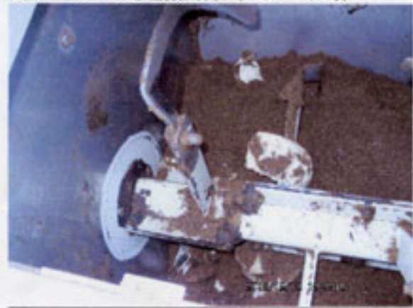
図7 生ゴミ処理機内部 (スタート時)
